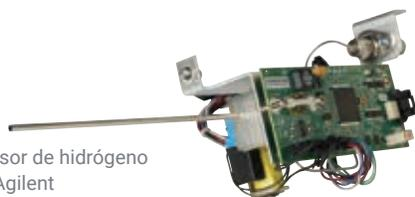
Sensor de hidrógeno de Agilent
